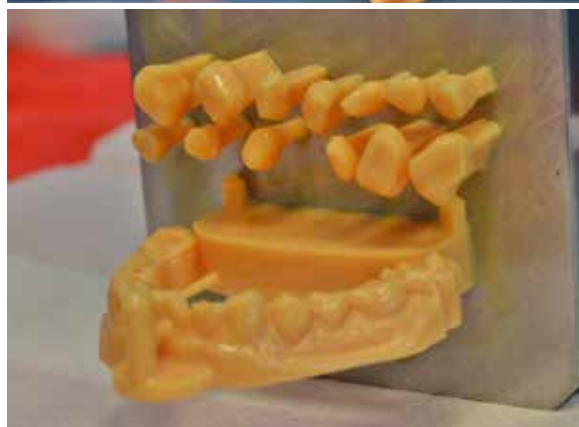
Abb. 10 u. 11: Das Drucken der Einzelstümpfe für den Oberkiefer und des Unterkiefermodells.
