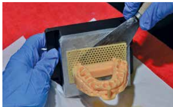
Abb. 8: Entnahme des gedruckten Modells und vorsichtiges Abheben von der Bauplattform.
