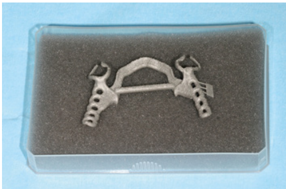
Abb. 11: Gelieferte Modellgussstruktur, die im Laserschmelzverfahren hergestellt wurde.
